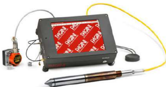
Figura 50: Strumentazione utilizzata per la prova CPTU
