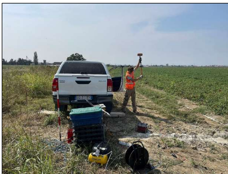
Figura 28: Fase di energizzazione durante l'acquisizione dati.
