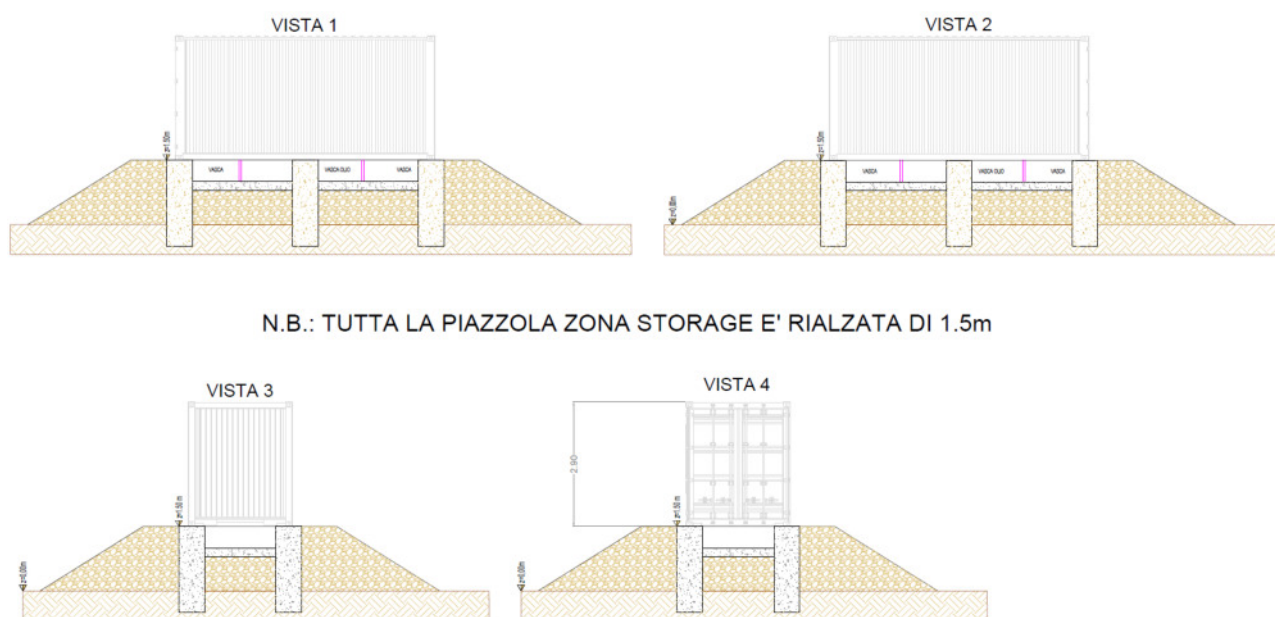
Figura 5-8. Viste dei container PCS estratte dall'elaborato "Disegno Architettonico Container Batterie e PCS" (cod. elab. RNE21.PD.T.19.00)
