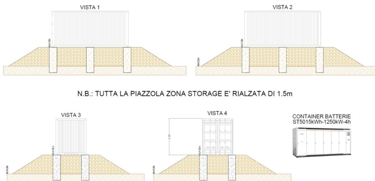
Figura 5-7. Viste dei container batteria estratte dall'elaborato "Disegno Architettonico Container Batterie e PCS" (cod. elab. RNE21.PD.T.19.00)
