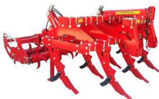
Figura 5-27. Macchine operatrici per la lavorazione dei terreni: a sinistra ripuntatore (o ripper) con rullo frantumatore; a destra erpice frangizolle
