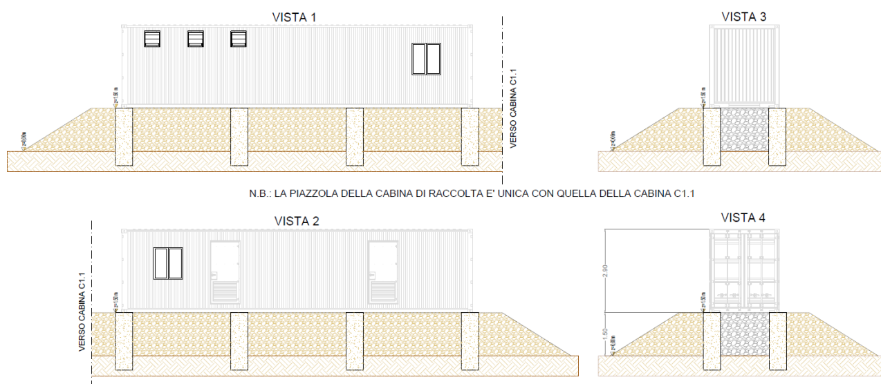
Figura 3–9. Viste esterne della cabina di raccolta estratta dall’elaborato “Disegno architettonico Altri Edifici” (cod. elab. RNE21.PD.T.18.00)
