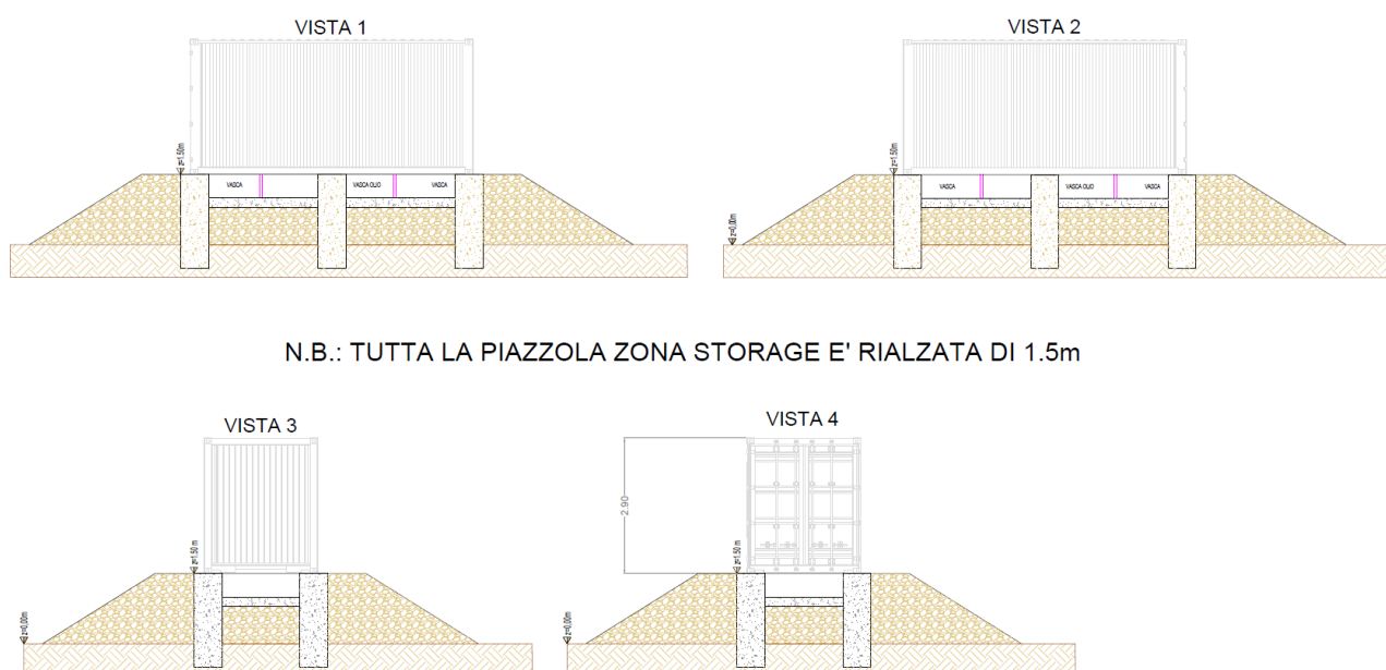
Figura 3–11. Viste dei container PCS estratte dall’elaborato “Disegno Architettonico Container Batterie e PCS” (cod. elab. RNE21.PD.T.19.00)
