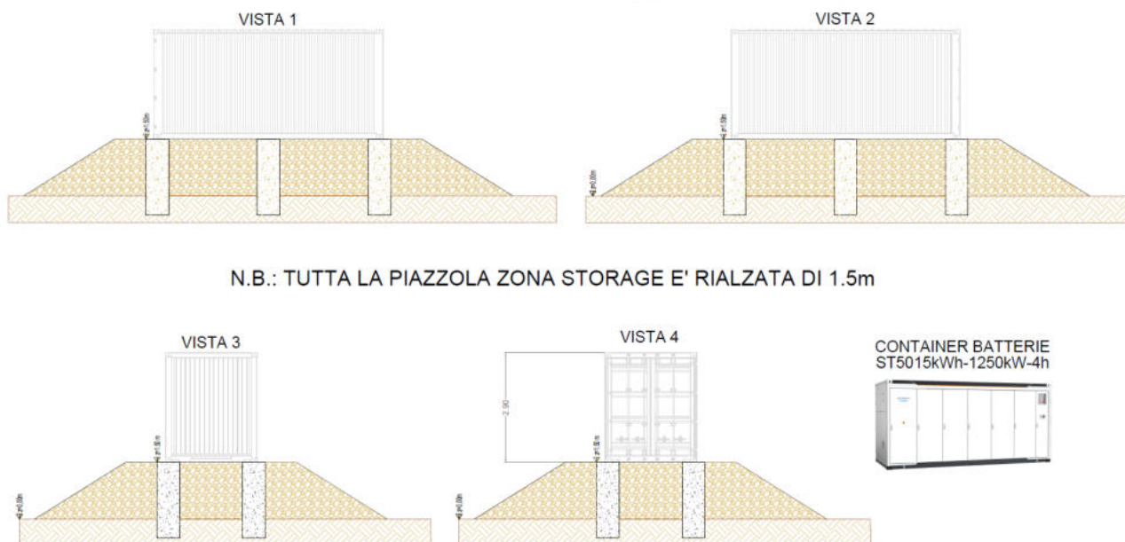
Figura 6-7. Viste dei container batteria estratte dall'elaborato "Disegno Architettonico Container Batterie e PCS" (cod. elab. RNE21.PD.T.19.00)
