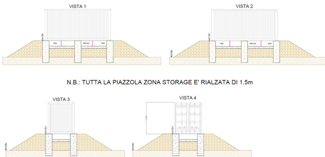
Figura 6-8. Viste dei container PCS estratte dall'elaborato "Disegno Architettonico Container Batterie e PCS" (cod. elab. RNE21.PD.T.19.00)
