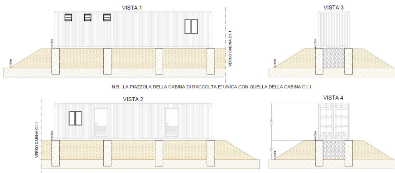
Figura 6-6. Viste esterne della cabina di raccolta estratta dall’elaborato “Disegno architettonico Altri Edifici” (cod. elab. RNE21.PD.T.18.00)
