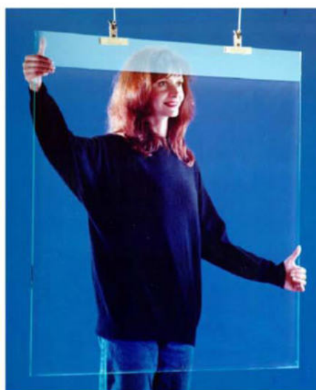
Figura 10-7. Le due immagini dimostrano come, al contrario di un vetro comune, il vetro anti-riflesso (Anti-Reflecting glass) che riveste i moduli fotovoltaici riduca drasticamente la riflessione dei raggi luminosi
