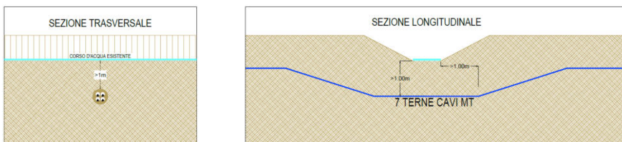
Figura 6-17. Sezione attraversamento con cavidotto del fosso irriguo (interferenza ID 18)
