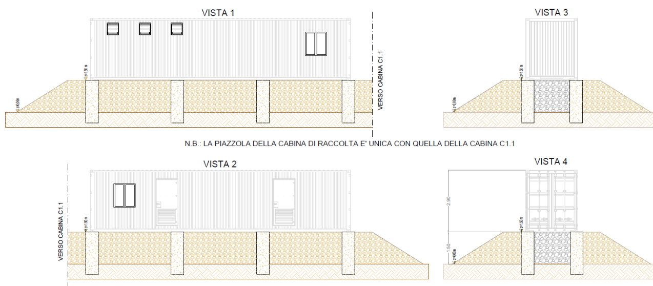
Figura 4-6. Viste esterne della cabina di raccolta estratta dall’elaborato “Disegno architettonico Altri Edifici” (cod. elab. RNE21.PD.T.18.00)
