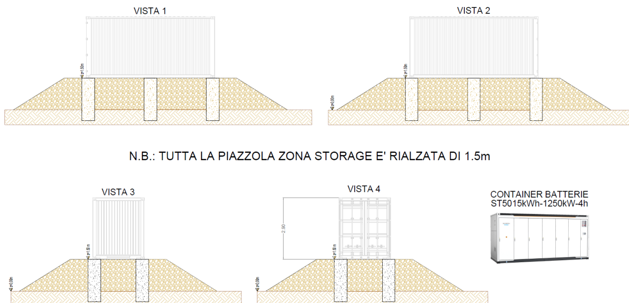
Figura 4-7. Viste dei container batteria estratte dall'elaborato "Disegno Architettonico Container Batterie e PCS" (cod. elab. RNE21.PD.T.19.00)
