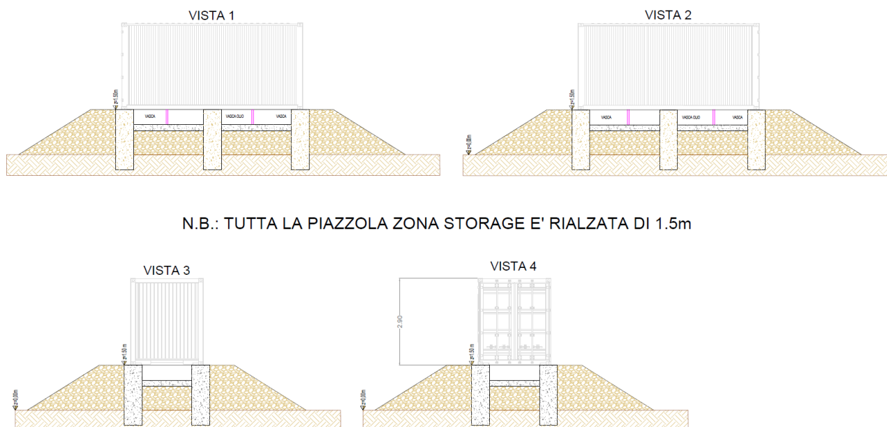
Figura 4-8. Viste dei container PCS estratte dall'elaborato "Disegno Architettonico Container Batterie e PCS" (cod. elab. RNE21.PD.T.19.00)
