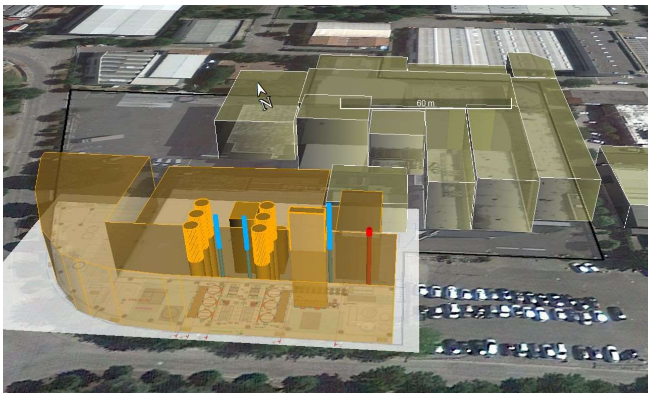
Figura 9. Ricostruzione 3D dei principali edifici dell'impianto che potrebbero dare origine a Building Downwash.
