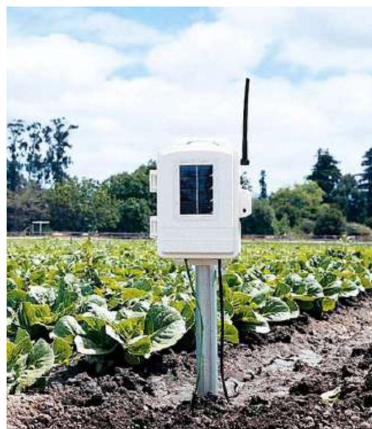
Figura 38 - Stazione agrometeorologica e sensori IoT in campo
