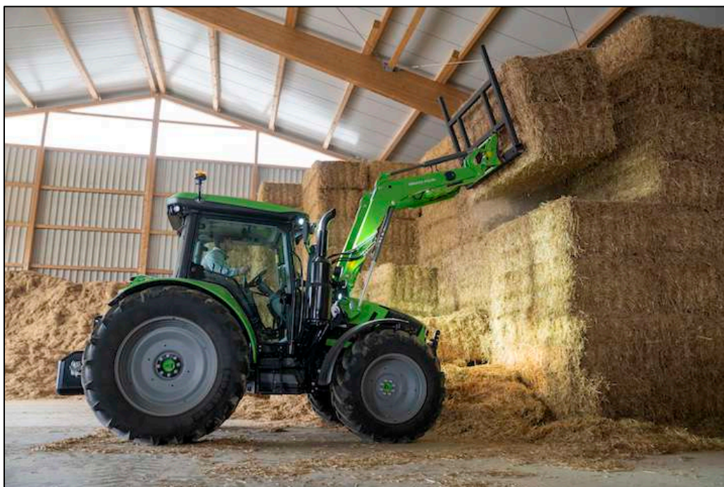
Figura 78: esempio caricatore frontale per movimentazione foraggi, usato in campo sotto impianto agrivoltaiico per carico foraggi imballati e successivo scarico in azienda agricola.
