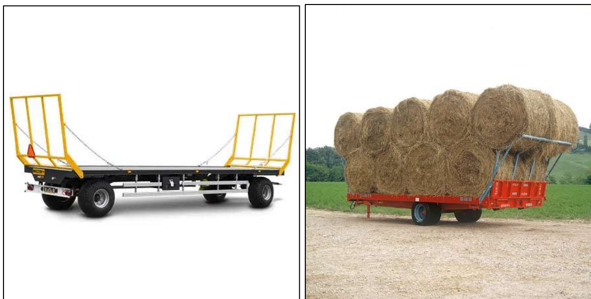
Figura 88: esempi rimorchi con pianale di carico standard (1 o 2 assi).
