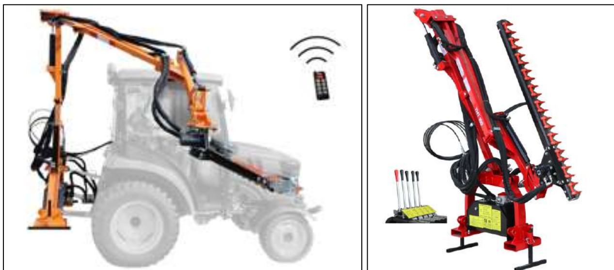
Figura 73: esempi di mezzi agricoli adattati per lavorare nelle interfile degli impianti agrivoltaici.
