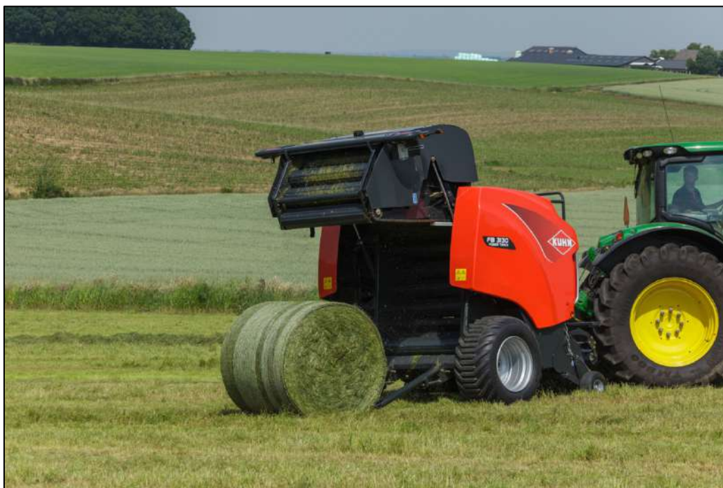
Figura 86: rotoimballatrice a camera fissa in fase operativa (Operazione 4)
