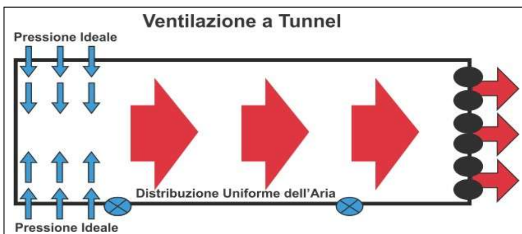
Schema tipologia di ventilazione a tunnel (da Guida COBB alla gestione del Broiler)
