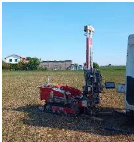
Figura 8-2 – Penetrometro TG63-200
