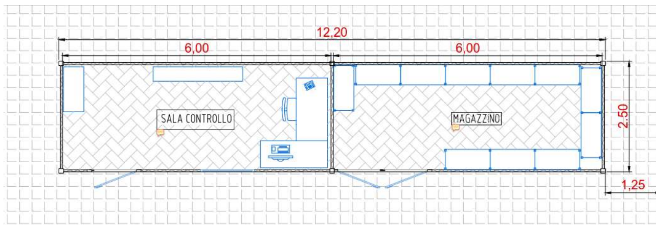
Figura 4-21 Layout container magazzino e sala controllo
