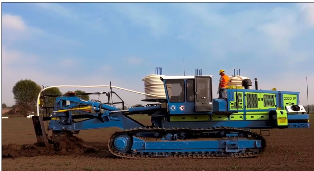
Figura 3-3. Macchina posadreni con sistema di posa a “ripper”
