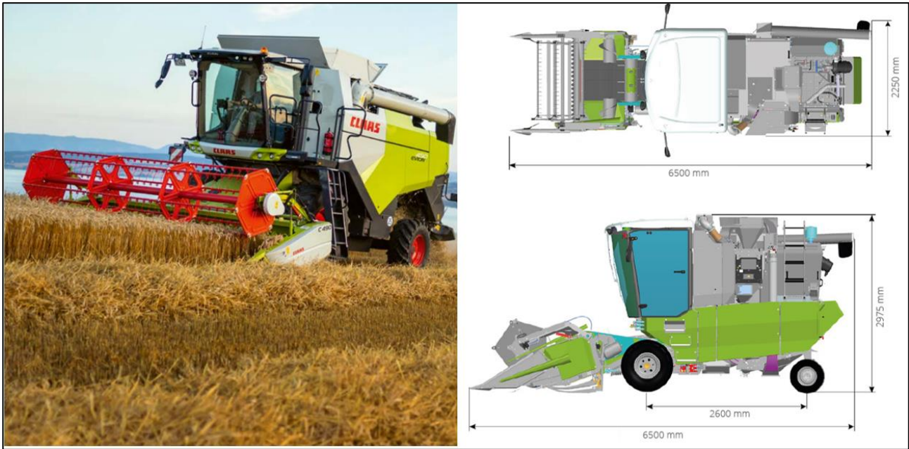
Figura 6-5- a sinistra: mietitrebbia con larghezza di lavorazione massima di 6,8 m; mietitrebbia per parcelle sperimentali con fronte di lavorazione di 2 m e altezza di 3 m. Entrambe potenzialmente compatibili con l'impianto agrivoltaico
