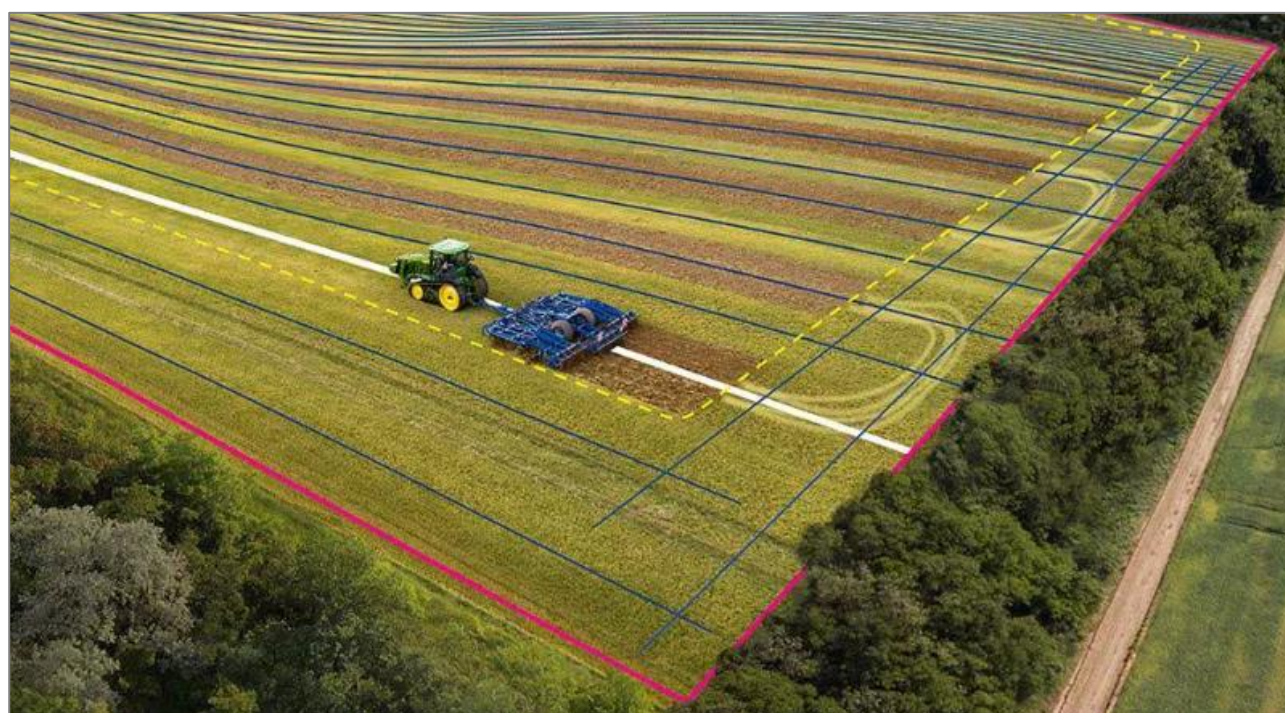
Figura 83: Esempio di sistemi di guida di precisione semiautonomia – AutoPath di John Deere
