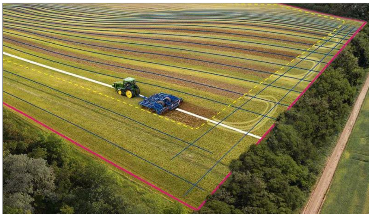
Figura 6: Esempio di sistemi di guida di precisione semiautonomia – AutoPath di John Deere
