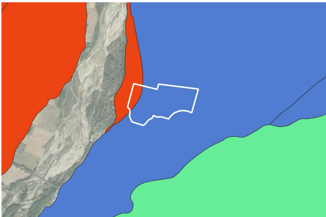
Figura 3.3: Tessitura dei suoli, Fonte: Ambienti deposizioni e litologie – Regione Emilia Romagna. In bianco la recinzione in progetto, in rosso il deposito di ghiaia, in blu il deposito di limo
