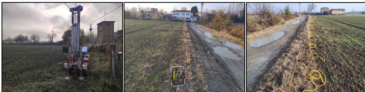
Figura 5.1: Indagini geognostiche: prova penetrometrica, prospezione geofisica MASW e tomografia geoelettrica.
