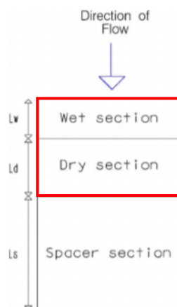
Figura 7.10: Modulo tipo, descrivente il modello concettuale idrologico dell'installazione di strutture fotovoltaiche a tracker su pali infissi comprendente l'area pannelli (in rosso) e l'area di interfila (Fonte: Hydrologic response of solar farm Cook 2013 American Society of Civil Engineers).
