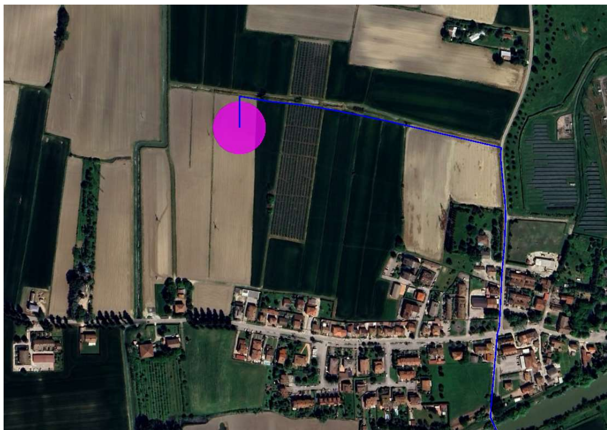
Figura 4 - Inquadramento su base ortofoto delle opere in progetto. In rosso l'area di impianto; in ciano l'area di progetto; in blu il cavidotto 36 kV; in magenta la futura SE Terna.
