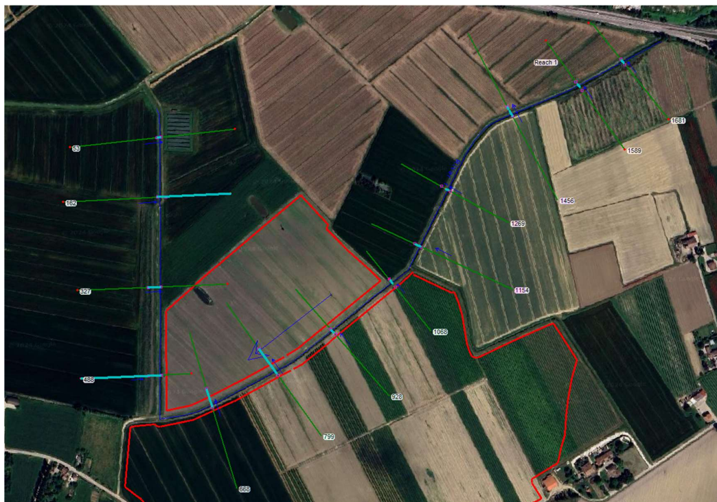
Figura 20 - Risultati per il canale maggiore per tempo di ritorno 200 anni (in celeste chiaro, lungo ogni sezione, il tratto occupato dalle acque)
