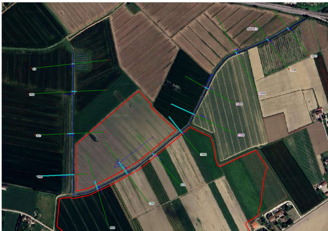
Figura 19 - Risultati per il canale maggiore per tempo di ritorno 100 anni (in celeste chiaro, lungo ogni sezione, il tratto occupato dalle acque)
