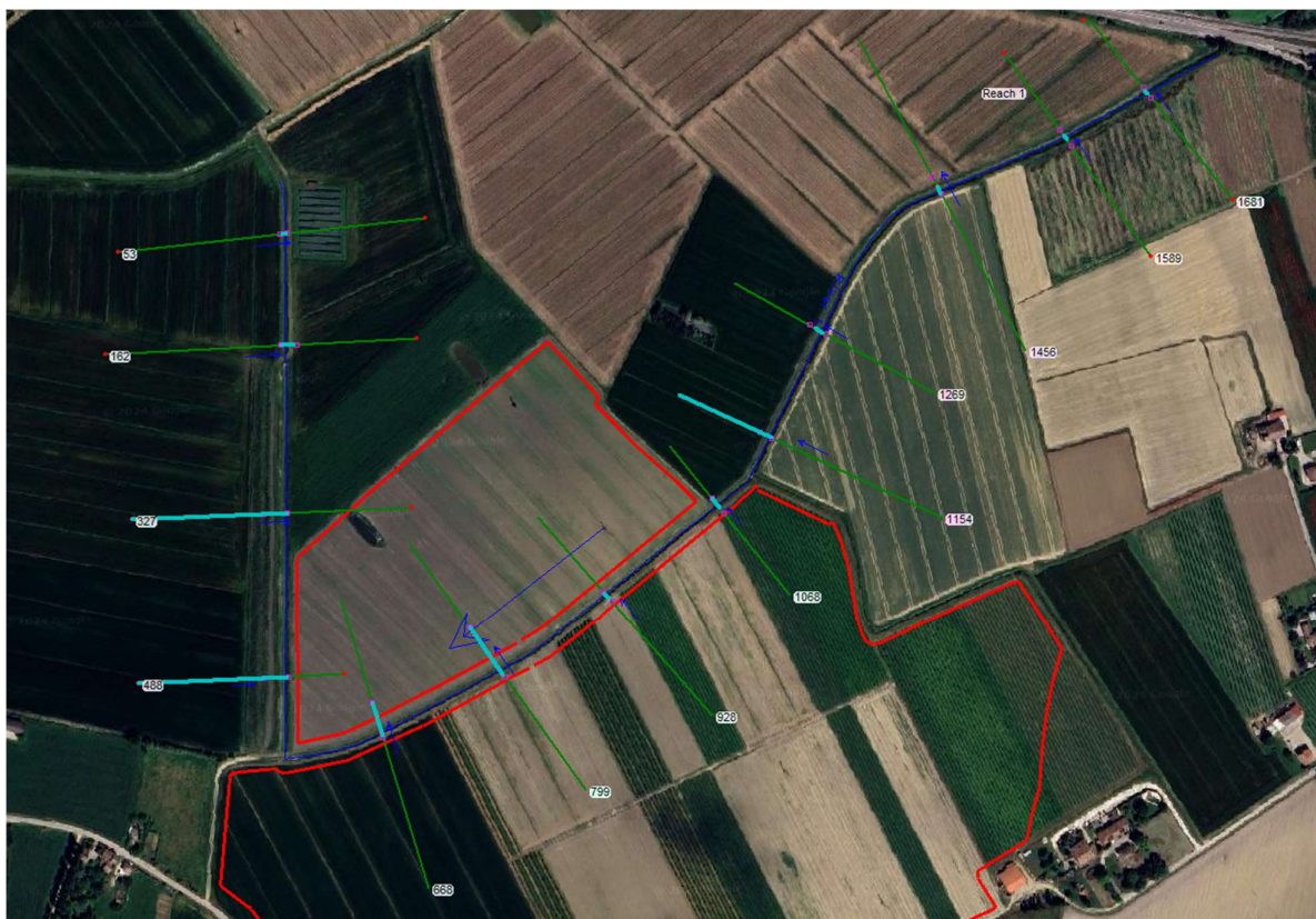
Figura 18 - Risultati per il canale maggiore per tempo di ritorno 50 anni (in celeste chiaro, lungo ogni sezione, il tratto occupato dalle acque)
