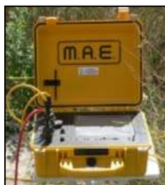
Fig. 2: sismografo multicanale M.A.E. modello A 6000 S.
