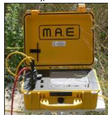
Fig. 3: sismografo multicanale M.A.E. modello A 6000 S.
