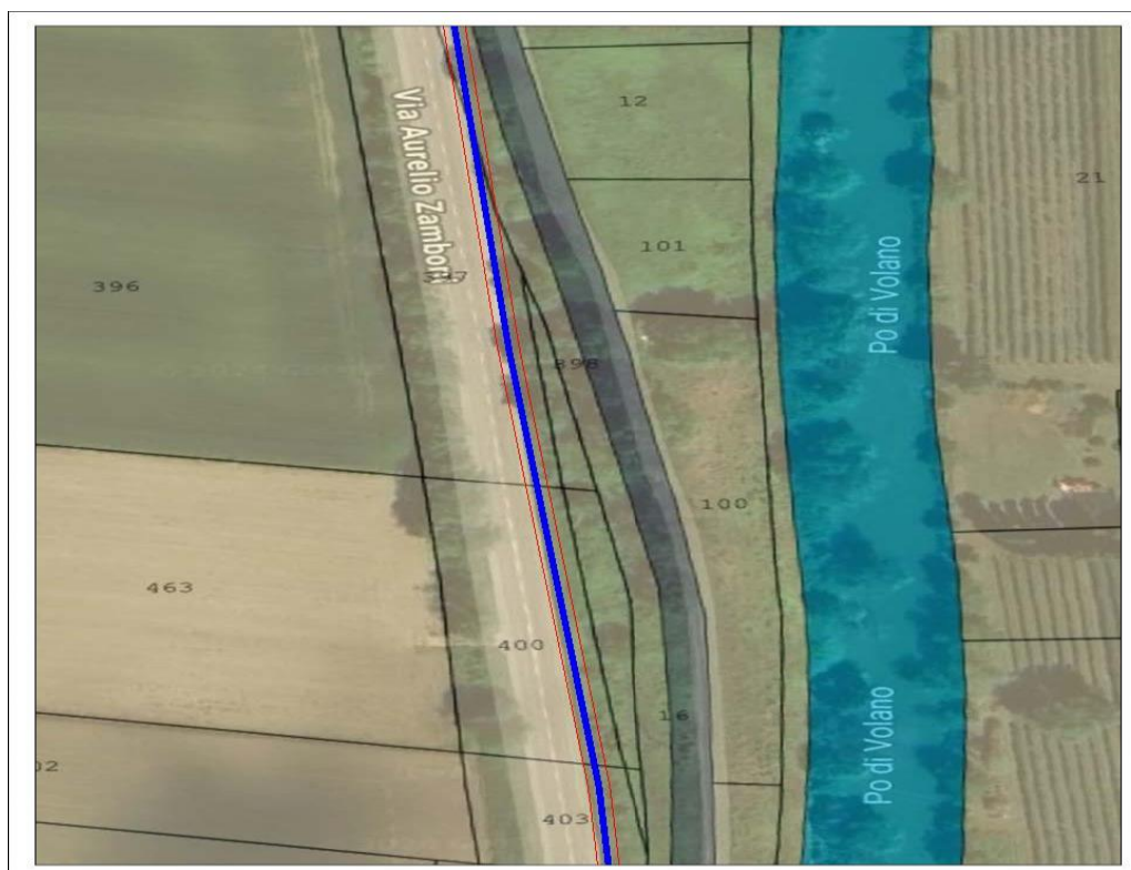
Figura 5 - Esempi di disallineamenti catastali tra le strade pubbliche ed esistenti e il WMS ufficiale dell'agenzia delle Entrate. In Blu il cavidotto. Si nota come le strade non siano accatastate/allineate come tali.
