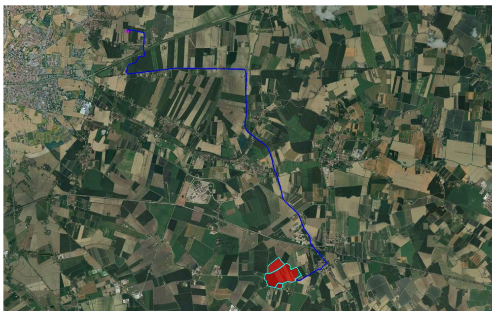
Figura 4 - Inquadramento su base ortofoto delle opere in progetto. In rosso l'area di impianto; in ciano l'area di progetto; in blu il cavidotto 36 kV; in magenta la futura SE Terna.
