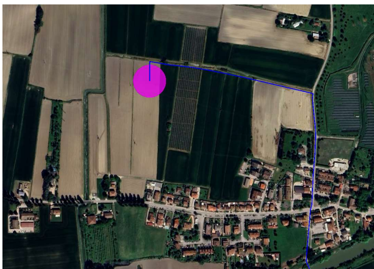
Figura 12 - Inquadramento su base ortofoto delle opere in progetto. In rosso l'area di impianto; in ciano l'area di progetto; in blu il cavidotto 36 kV; in magenta la futura SE Terna.
