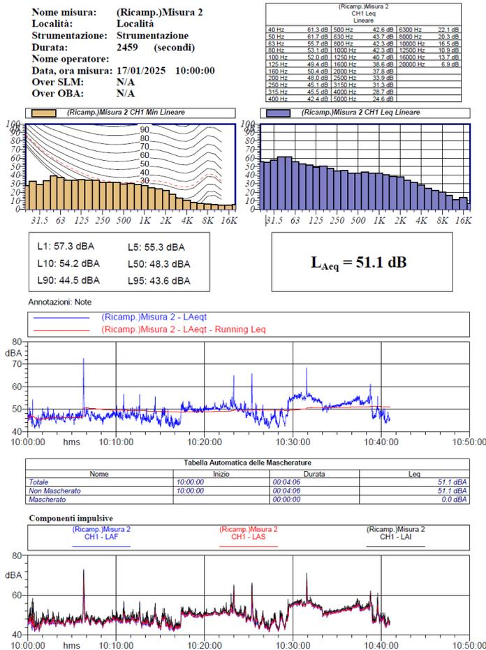
Si considera la sezione delle misure in cui non c'è passaggio di macchine per poter valutare lo scenario a favore di sicurezza.
