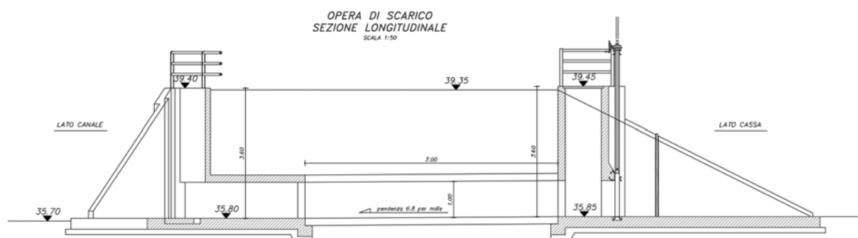
Figura 38 - Sezione tipologica opera di scarico
