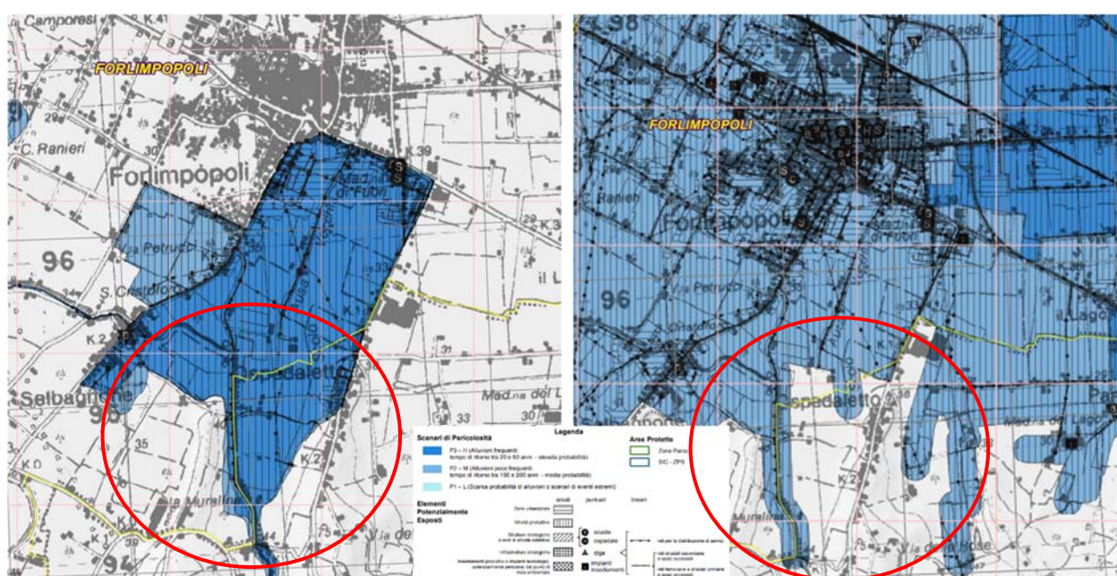
Figura 8. Estratto della mappa pericolosità ed elementi esposti reticolo principale (a sinistra) e secondario (a destra).
