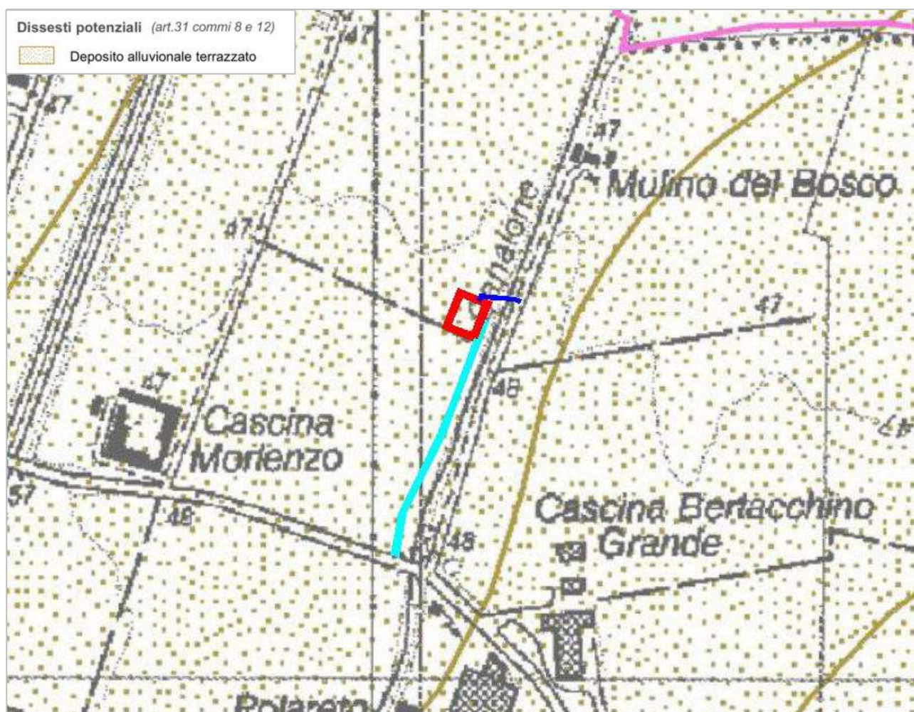
Figura 40: Stralcio della Tavola A3 "Carta del dissesto"; in rosso è indicata l'area della sottostazione elettrica MT/AT, in blu la linea di connessione AT e in azzurro il percorso di accesso alla sottostazione di progetto.
