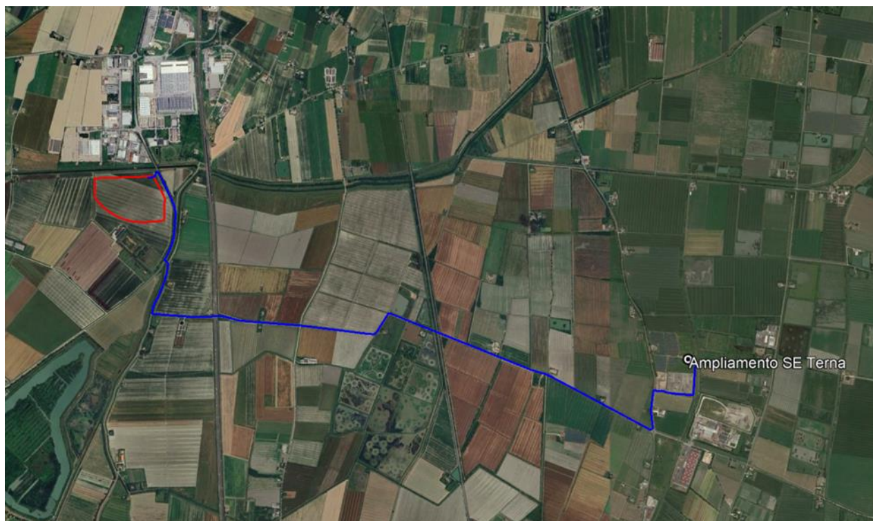
Figura 3 – Area di impianto su base ortofoto (in rosso), del tracciato del cavidotto di connessione alla rete (in blu) - Fonte: Google Earth
