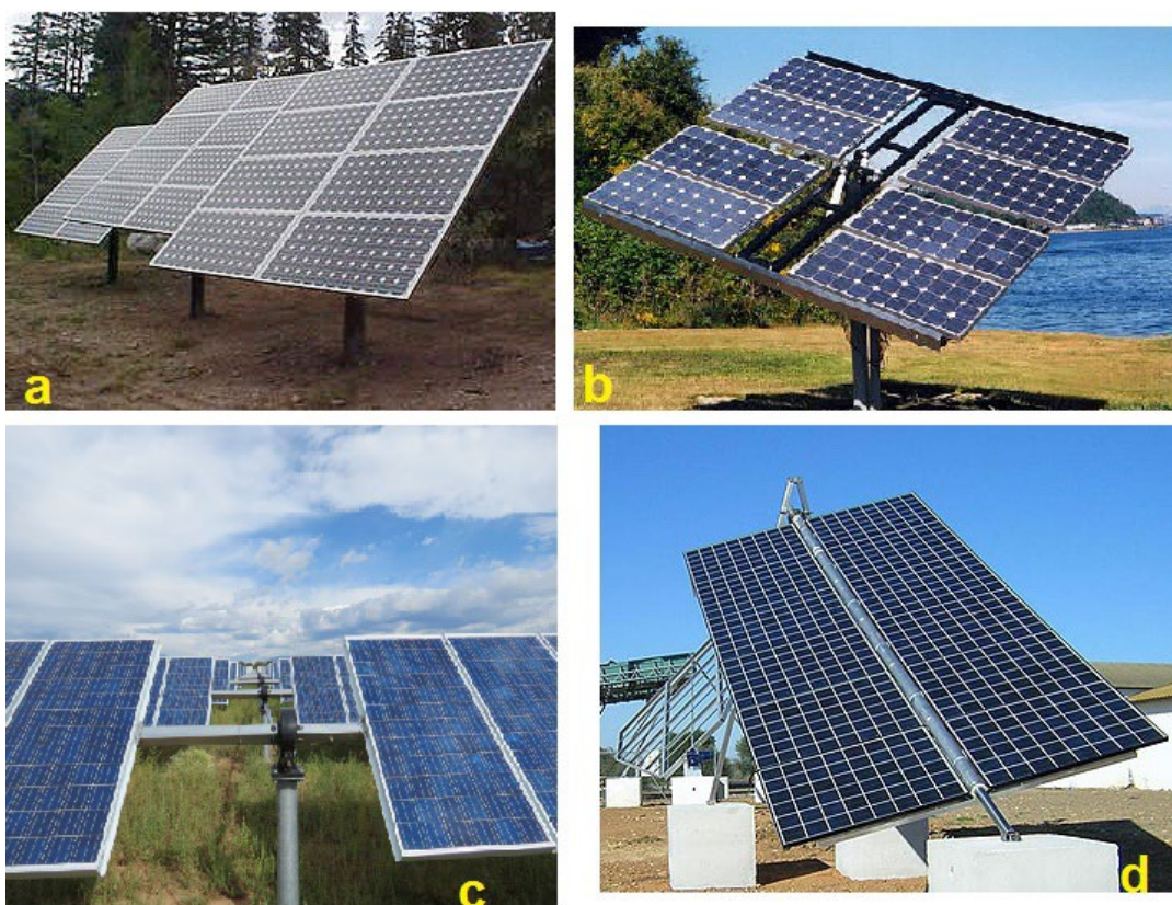
Figura 41 - Sistemi ad inseguimento: a) inseguitore di tilt, b) inseguitore di azimut, c) inseguitore di rollio, d) inseguitore ad asse polare.
