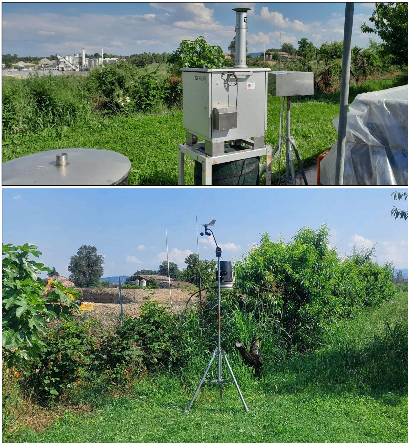
Figura 6: Posizionamento strumentazione di rilevamento: foto in alto, a sx campionatore polveri PM10 modello SKYPOST PM/HV, a dx campionatore sequenziale PTS modello SENTINEL 8Q; foto in basso, stazione meteorologica modello Davis Vantage Pro2.
