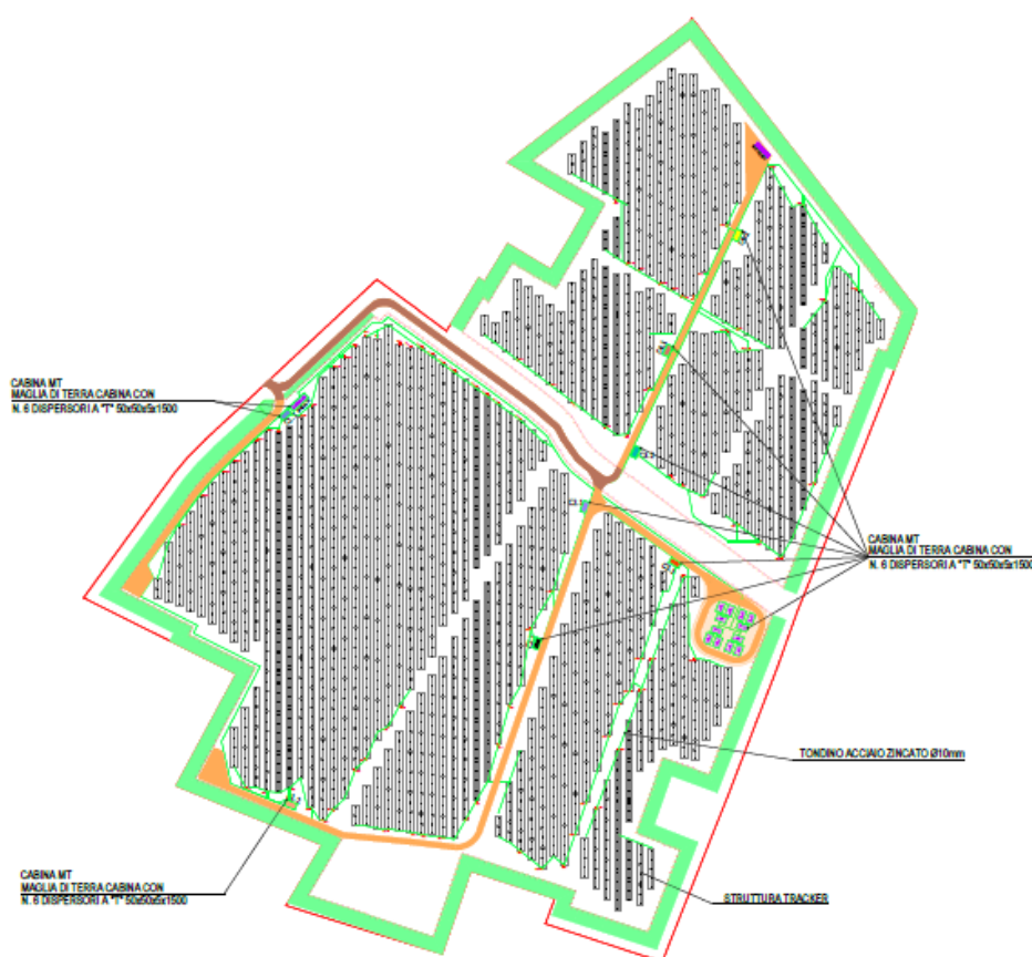
Figura 3: Rete equipotenziale impianto agrivoltaico
