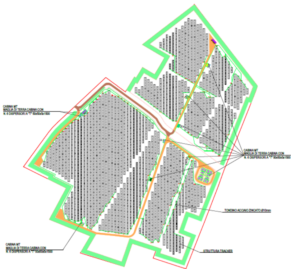
Figura 9: Rete equipotenziale impianto agrivoltaico
