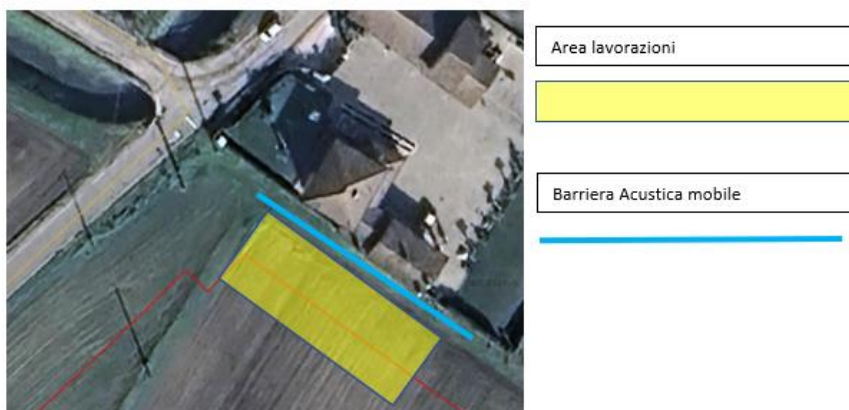
Figura 7: Schema tipo del posizionamento delle barriere - vicinanza di un ricettore critico
