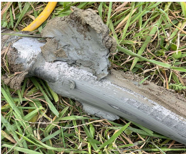
Sedimenti argillosi e limo argillosi individuati tramite la campagna geognostica
