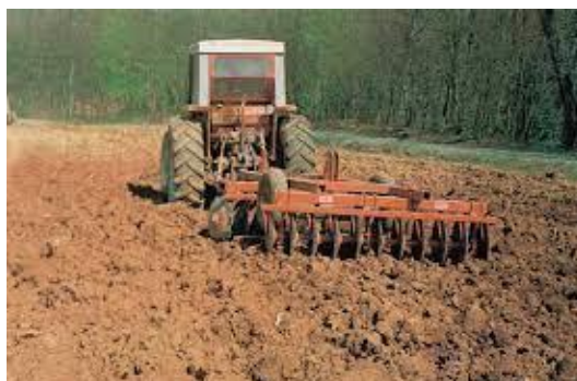
Figura 5-27. Macchine operatrici per la lavorazione dei terreni: a sinistra ripuntatore (o ripper) con rullo frantumatore; a destra erpice frangizolle
