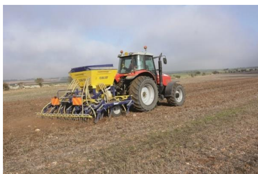
Figura 5-28. Macchine operatrici per la semina e per la trasemina: a sinistra seminatrice combinata; a destra seminatrice su sodo
