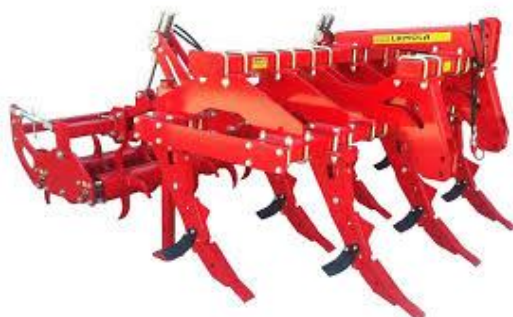
Figura 5-27. Macchine operatrici per la lavorazione dei terreni: a sinistra ripuntatore (o ripper) con rullo frantumatore; a destra erpice frangizolle
