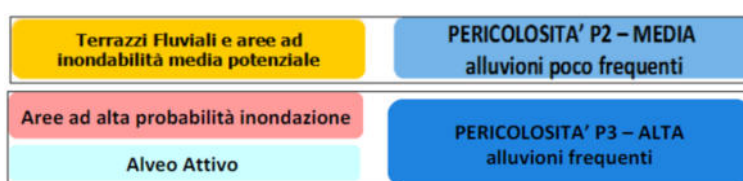
Figura: Schema di utilizzo delle perimetrazioni contenute nella pianificazione di bacino nelle mappe della pericolosità per i tratti montani e collinari
