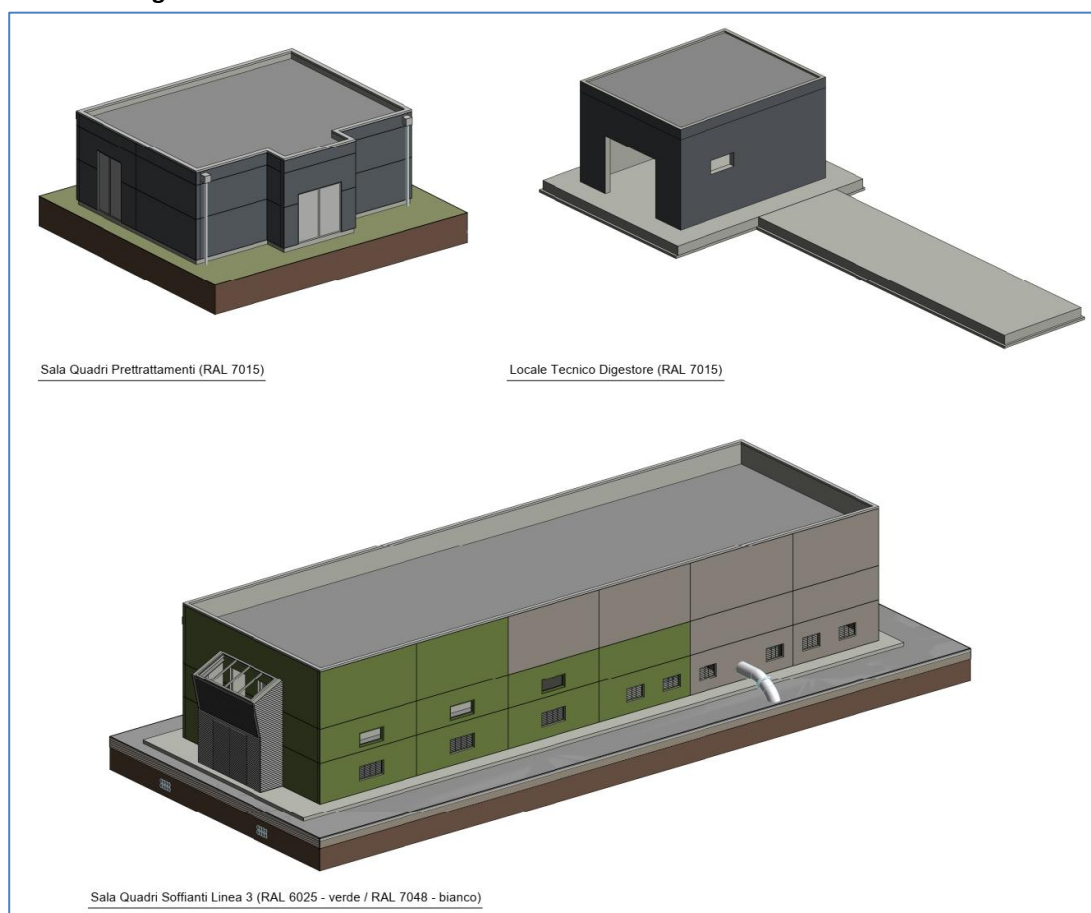
Figura 2-165 – Manufatti di nuova costruzione con intervento di verniciatura
