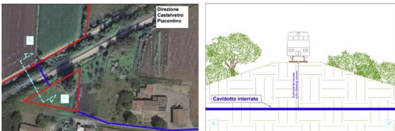
Figura 3.13 – Interferenza con la ferrovia
