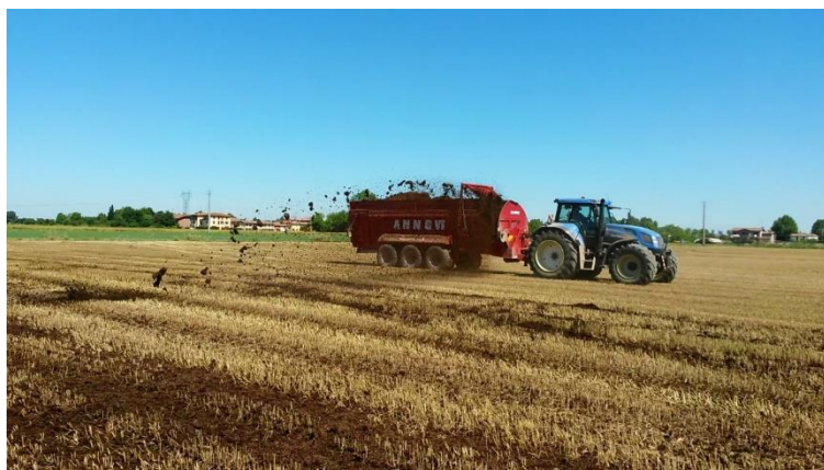
Figura 32 – Spandiletame con sistema di distribuzione posteriore a organi rotativi con asse verticale
