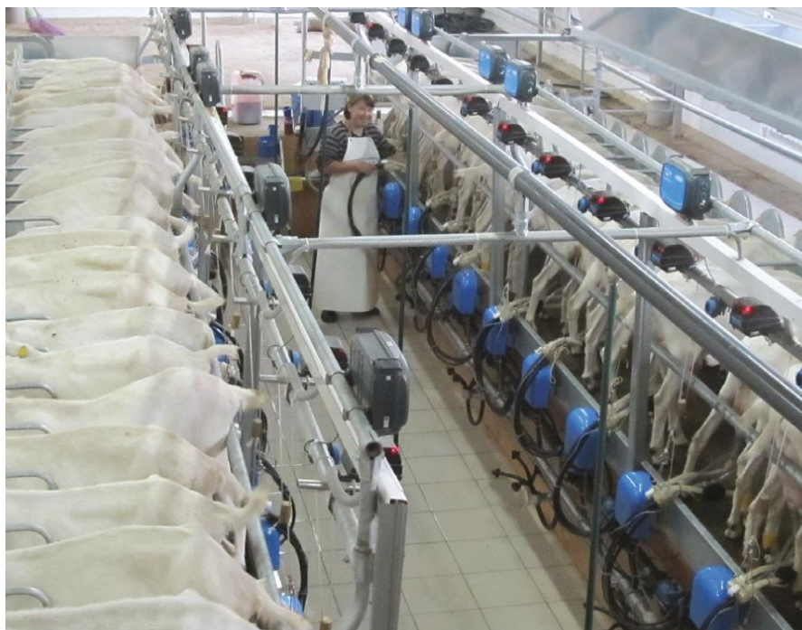
Figura 12 - Esempio sala di mungitura a pettine
