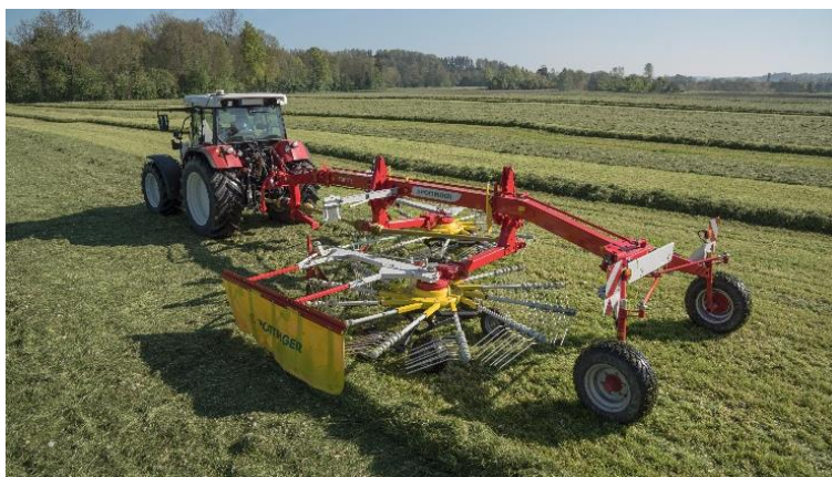
Figura 37 – Ranghinatore o andanatore a doppio rotore con scarico laterale
