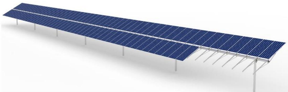
Figure 2-2: Strutture dei moduli fotovoltaici
