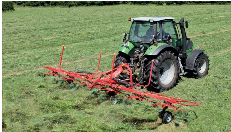
Figura 36 – Voltafieno portato da trattore
