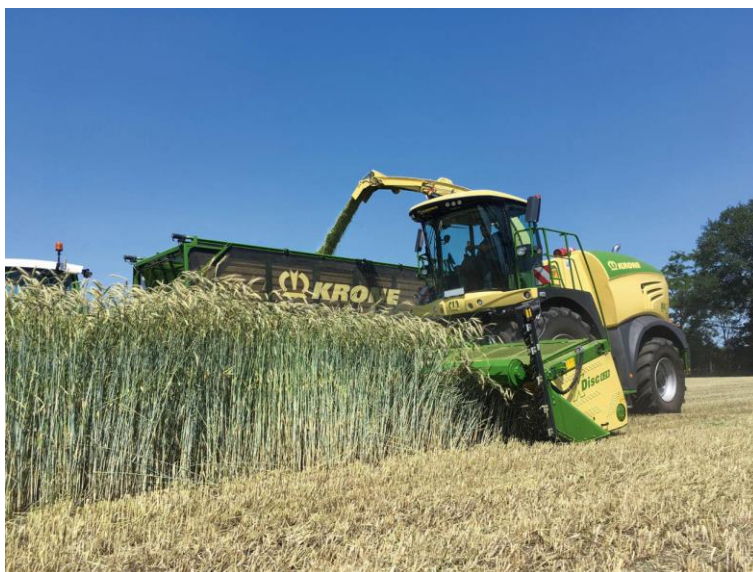
Figura 39 – Falcitrinciacaricatrice con testata da orzo
