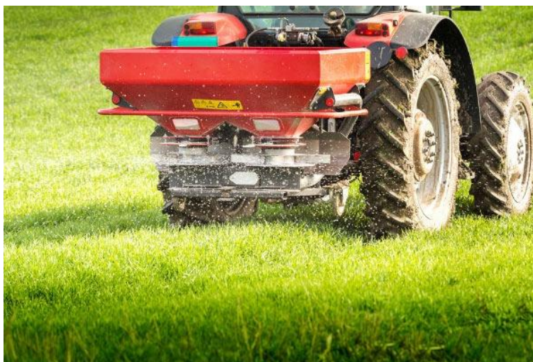
Figura 33 – Spandiconcime centrifugo
