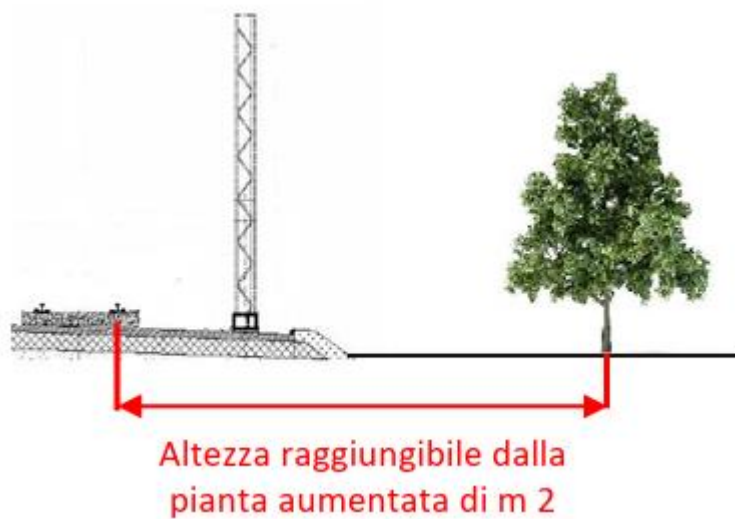
Figura 4.6: Distanza minima che deve esserci tra le piante di nuova piantagione e la rotaia più vicina.
