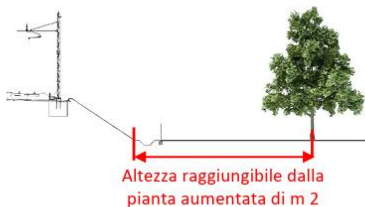
Figura 4.6: Distanza minima che deve esserci tra le piante di nuova piantagione e la rotaia più vicina.
