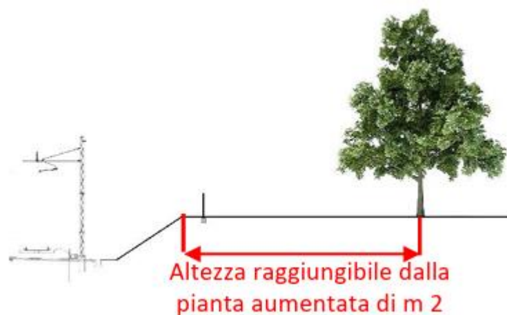
Figura 4.7 Distanza minima che deve esserci tra le piante di nuova piantagione e la rotaia più vicina: sopra, nel caso di ferrovia in rilevato, sotto, nel caso di ferrovia in trincea.
