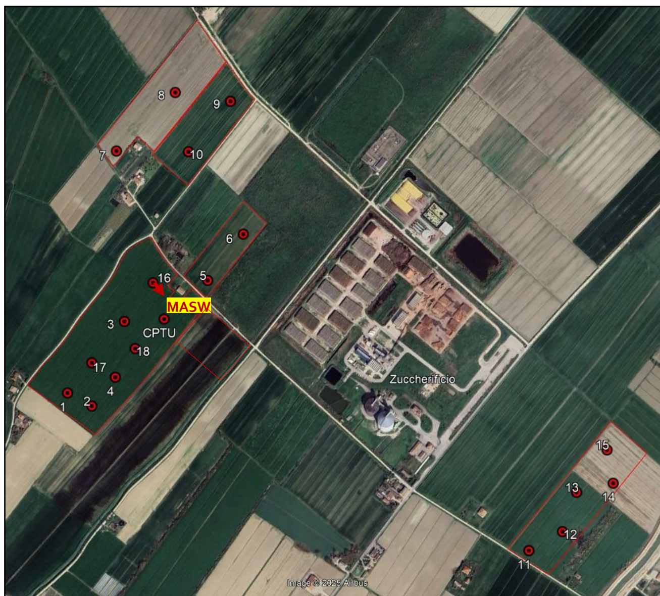
Fig. 3 -Ubicazione indagini geognostiche: CPT - prova penetrometrica statica; MASW - prova sismica
