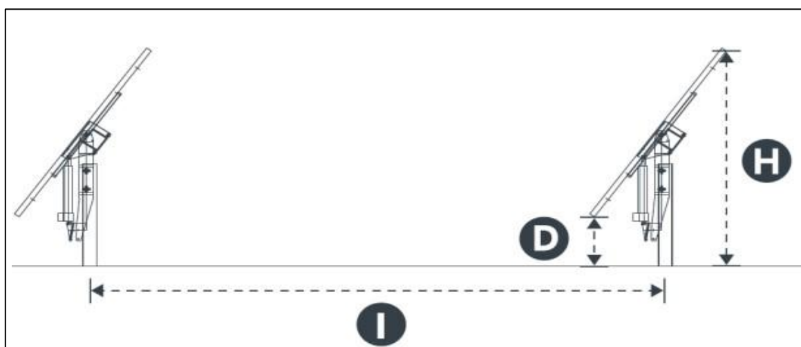
Figura 4: Profilo inseguitori monoassiali Est-Ovest
