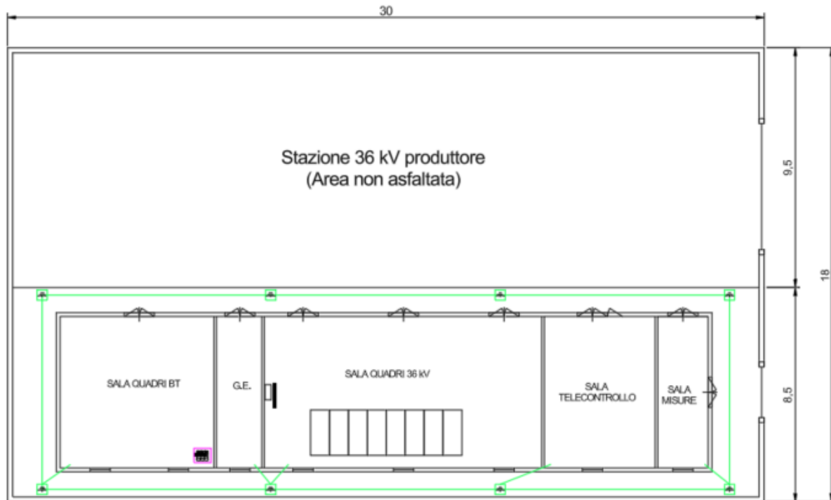
Figura 2: Cabina elettrica utente di sezionamento
