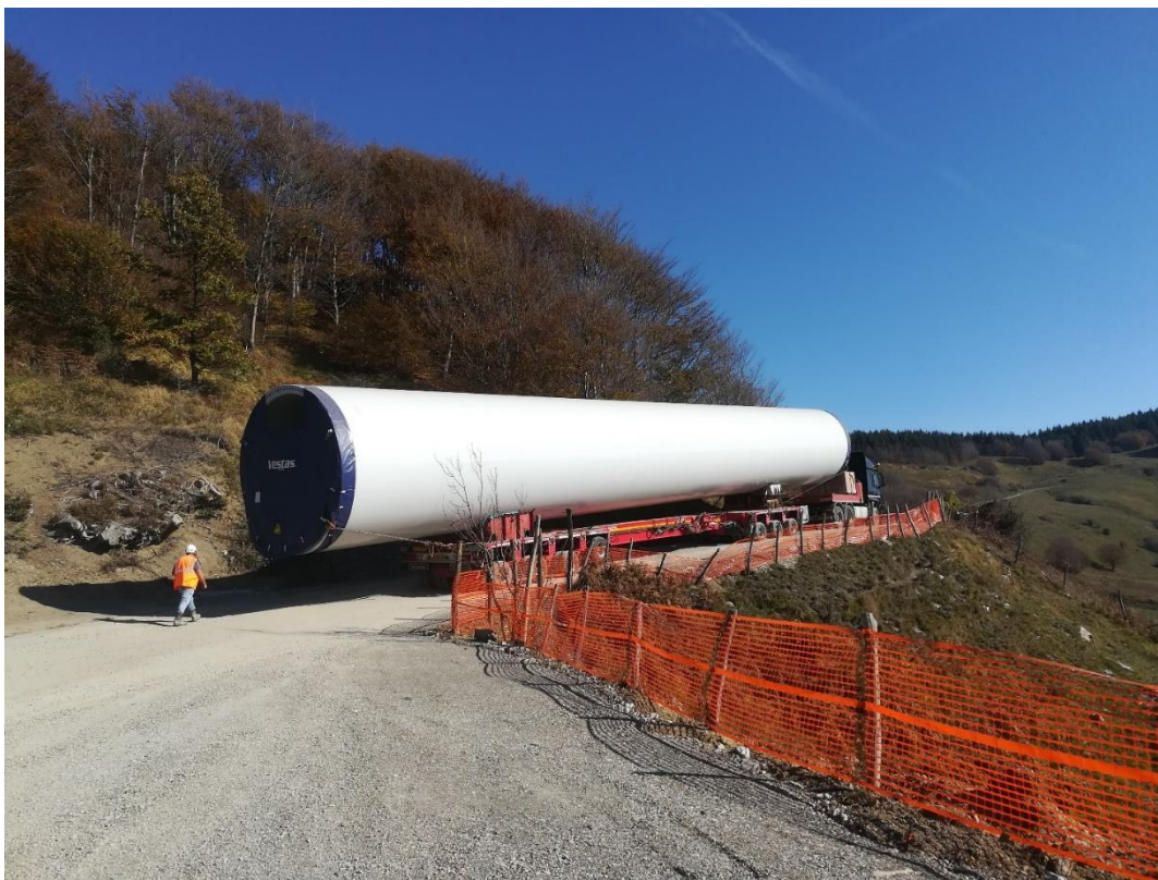
Figura 11: mezzo trasporto eccezionale speciale tronco di torre (semovente)
