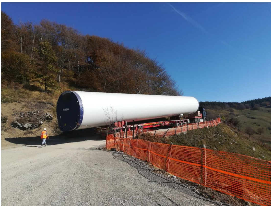
Fig. 11: mezzo trasporto eccezionale speciale tronco di torre (semovente)
