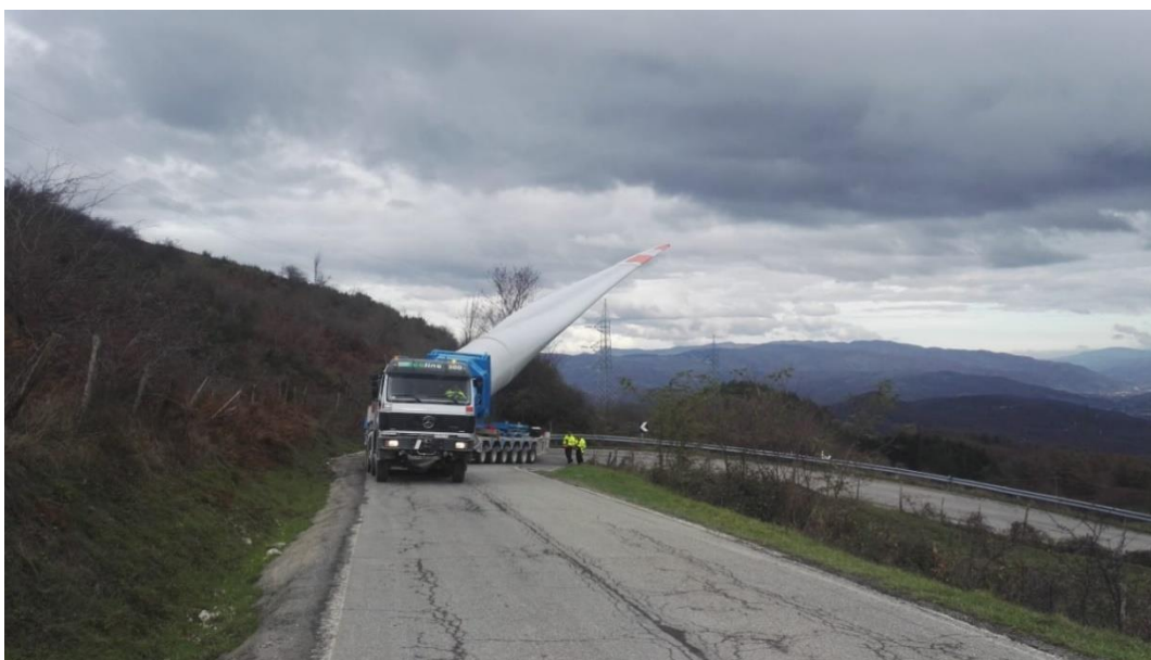
Figura 10: mezzo trasporto eccezionale speciale pala (blade lifter)
