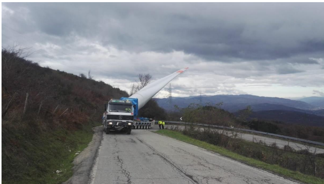
Fig. 10: mezzo trasporto eccezionale speciale pala (blade lifter)
