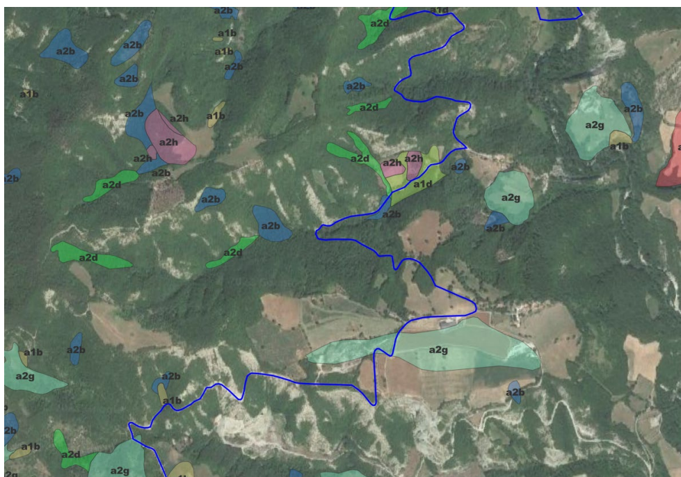
Figura 8 – Cavidotto di progetto con individuazione aree interessate da depositi di frana quiescenti e attivi
