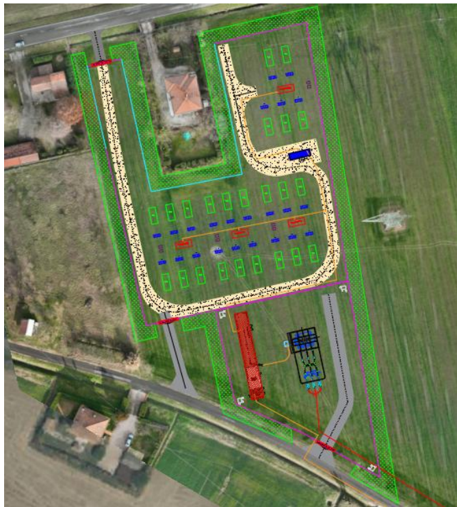
Figura 9: Sistema di accumulo e Sottostazione elettrica utente
