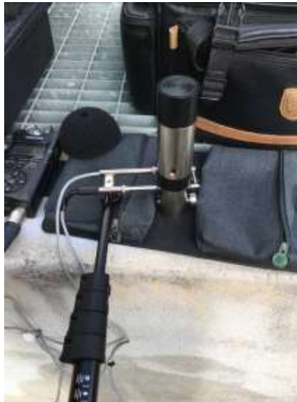
Figura 0.4C: Esempio di calibrazione della sonda intensimetrica
