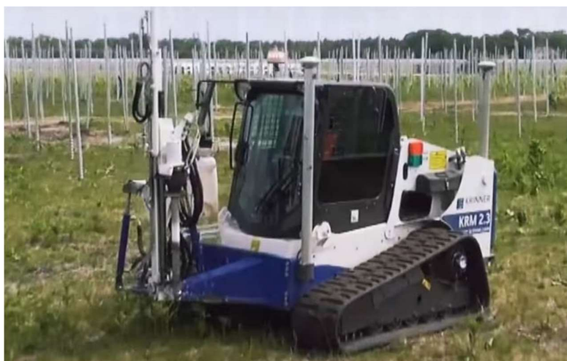
Figura 4. Esempio macchina battipalo per il fissaggio delle strutture
