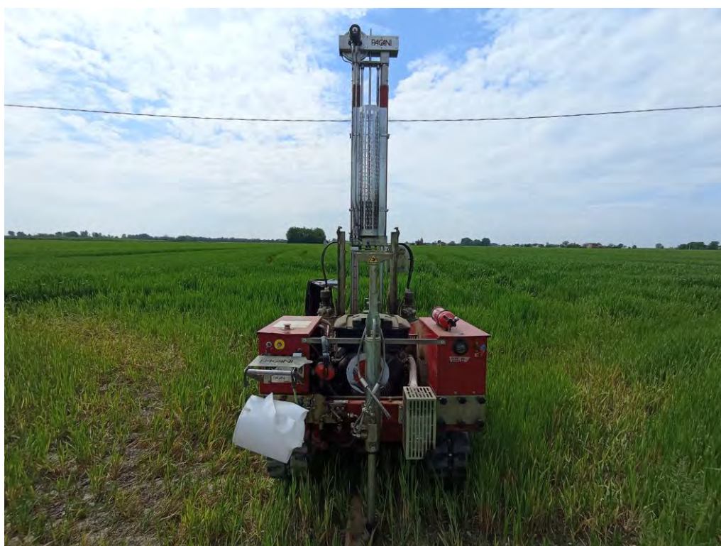
Figura 18 – Prova penetrometrica DPSH 7
