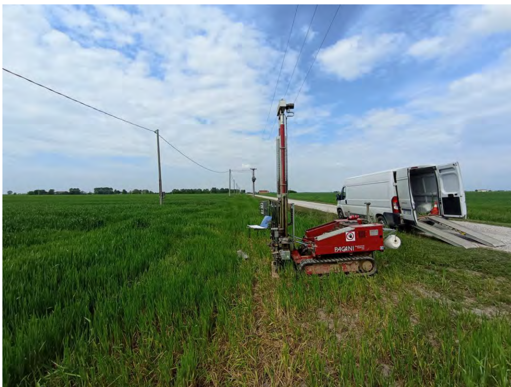
Figura 19 – Prova penetrometrica DPSH 8
