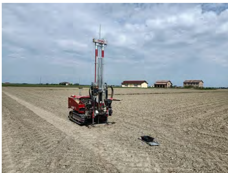
Figura 12 – Prova penetrometrica DPHS 1
