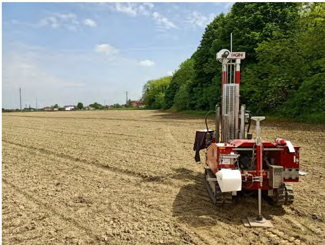
Figura 13 – Prova penetrometrica DPSH 2
