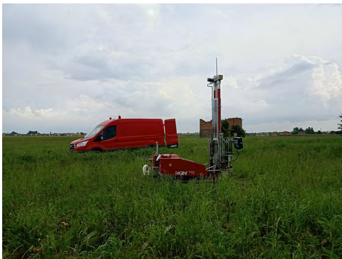
Figura 14 – Prova penetrometrica DPSH 3
