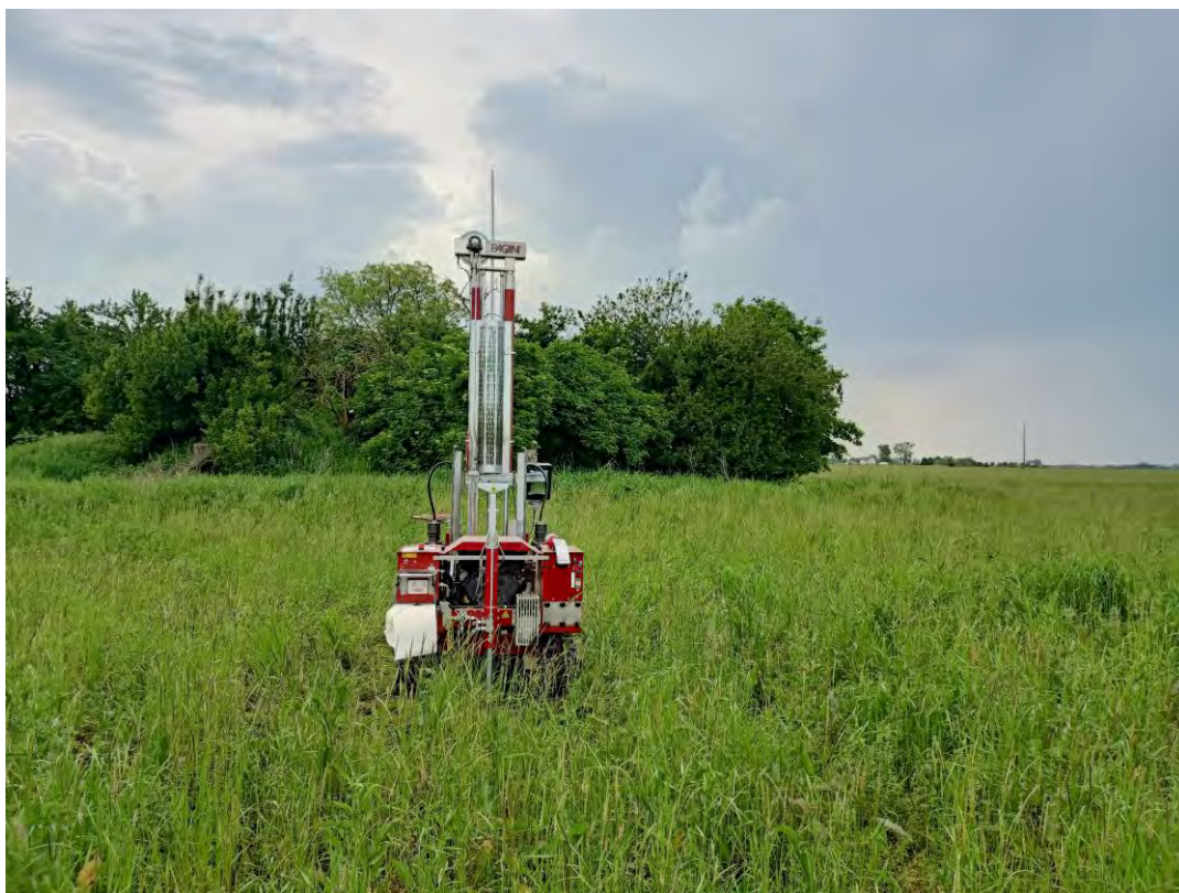
Figura 15 – Prova penetrometrica DPSH 4
