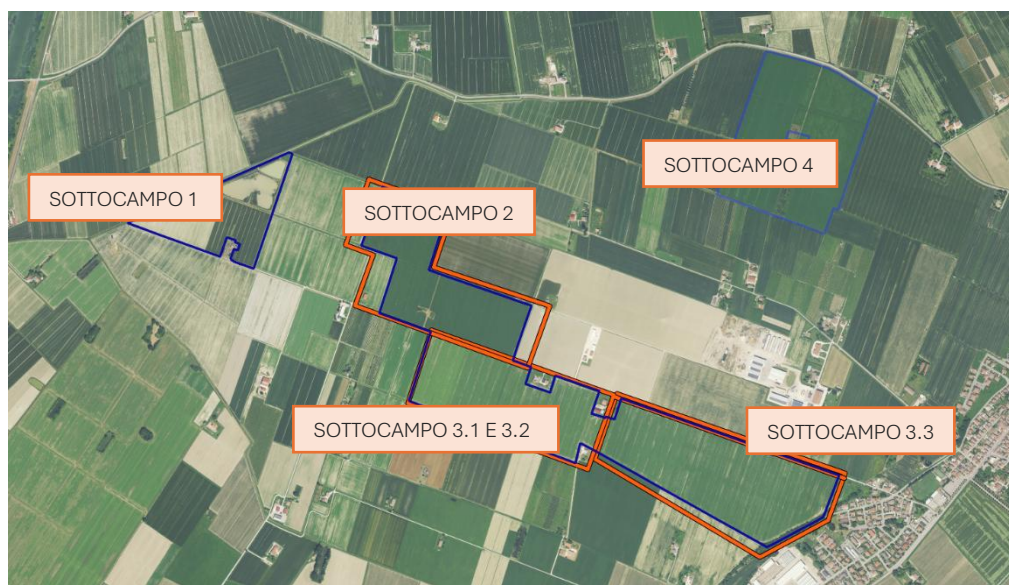
Figura 3. Divisione Sottocampi impianto agrovoltaico
