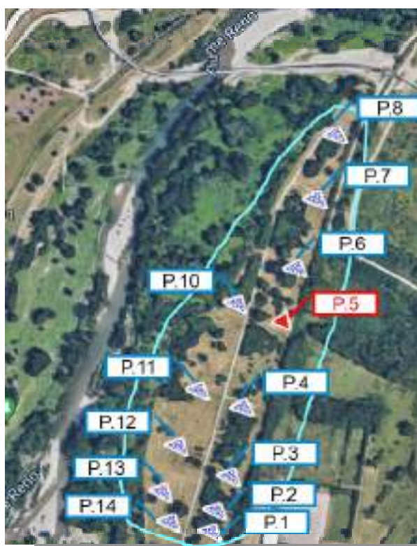
Figura 8- area della centrale Tiro a Segno: pozzi e impianto di trattamento acque; in rosso, i pozzi fuori esercizio (fonte: Google maps)
